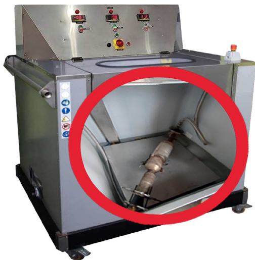
Filter umiestnený v stroji, namontovaný pomocou univerzálnych adaptérov
