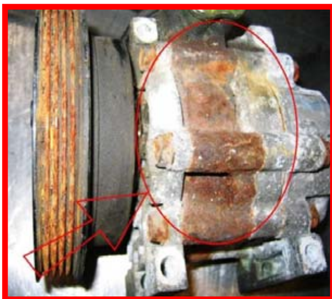
Zřejmý úbytek materiálu > 3 cm 2 .
