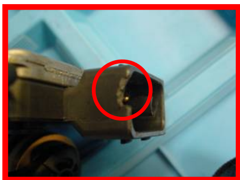
Zřetelné poškození konektoru
