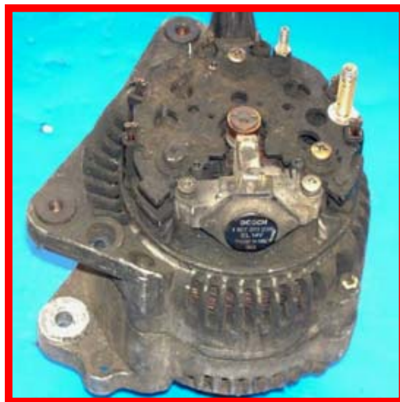
Chybí plastová krytka
